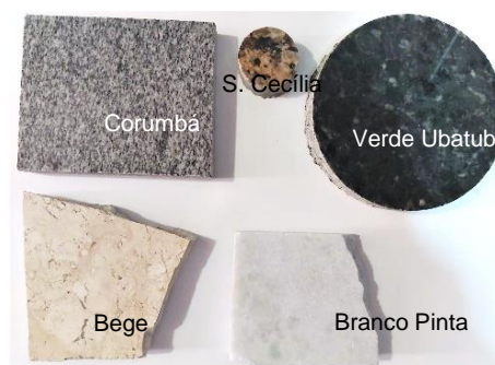
Figura 06: Rochas ornamentais: Granitos (Corumbá, Santa Cecília e Verde Ubatuba) e Mármores ( Bege Bahia e Branco Pinta). Fonte: Elaborado pelas autoras
