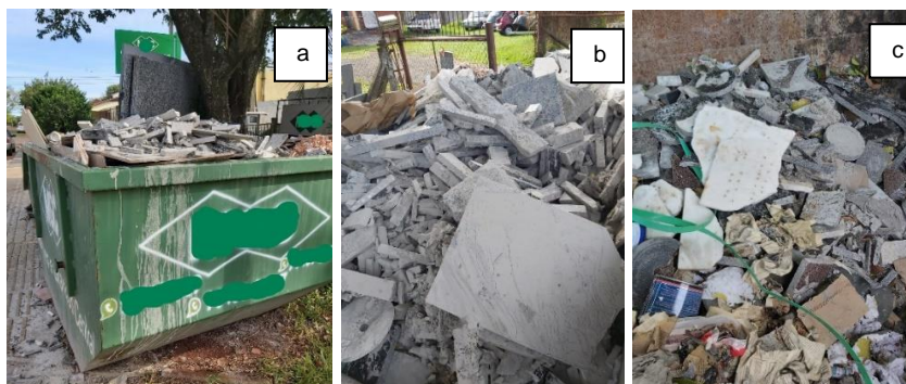
Figura 02: a) Caçamba material residual marmoraria b) Resíduos de marmoraria aproveitáveis c) Material residual de distintas naturezas. Fonte: Elaborado pelas autoras
