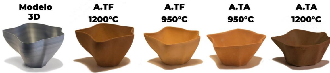
Figura 4: Peças finalizadas e matriz impressa 3D (Acervo do autor)
