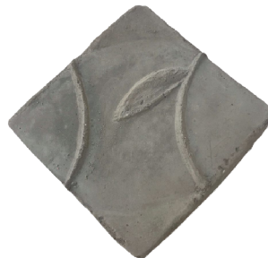
Figura 2 - Revestimento alto relevo feito com molde de XPS
