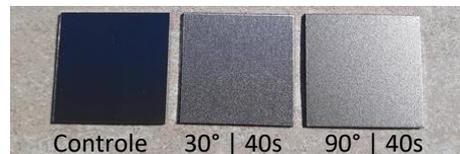
Figura 2. Controle e substratos após o shot peening por 40s a 30° e 90°
