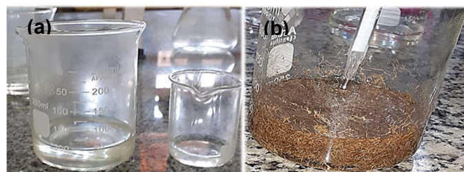
Imagem 3 – Componentes individuais (a) e sistema resina-endurecedor-fibra (b).
